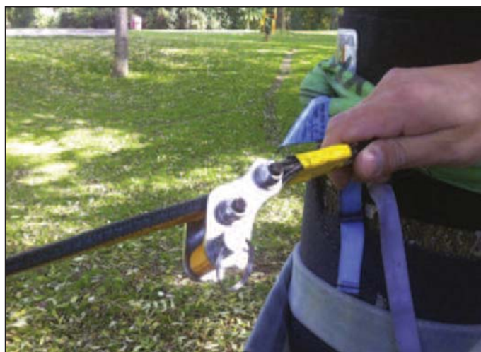
Bild 8: Falsch, um 180 Grad verdreht eingehängte Banane; Quelle: Thomas Buckingham
