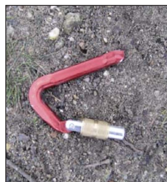
Bild 1: Gebrochener Aluminiumkarabiner; Quelle: Bernhard Witz
