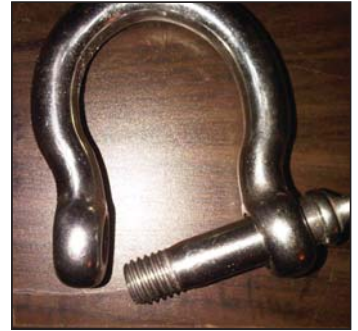
Bild 4: Nicht zugeschraubter Schäkel. Quelle: Facebook Profile/slackwerk aus Chemnitz, Oktober 2012,
