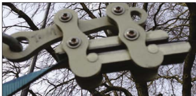
Bild 10: Falsch, um 180 Grad verdreht eingesetzte Linegrip Backe; Quelle: Thomas Buckingham)
