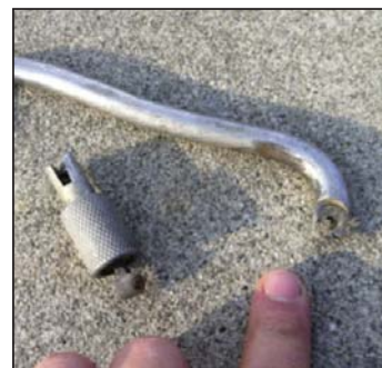
Bild 3: Aufgrund von Tri-Loading (Dreiecks oder Y-Belastung) gebrochener Stahlkarabiner; Quelle: Thomas Buckingham
