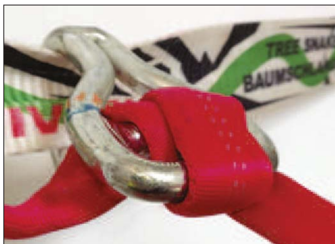
Bild 9: LineHook, bei dem durch Zugkraft auf dem losen Ende die Lagen voneinander gerutscht sind; Quelle: Pascal Graf
