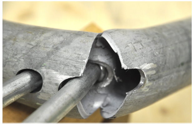
Spröbruch Biegezug bei Stange
