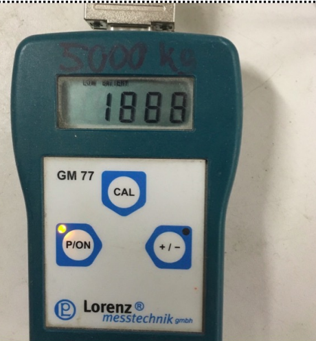
Bruchwert abz. ca 10% (Reibung in Umlenkrollen = ca. 17kN )
