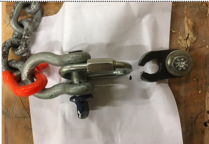
Bruchursache: Riss der Hakenlasche (t=ca 3mm)
