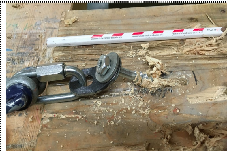
Bruchursache: Gewindeausriss aus dem Holz
