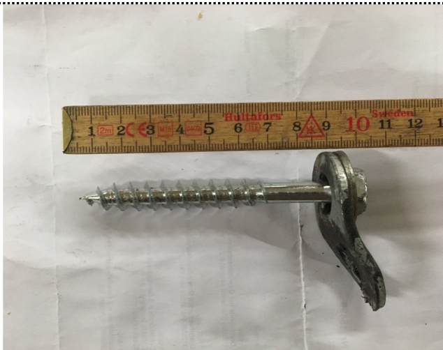
Verformung der Schraube: marginal
